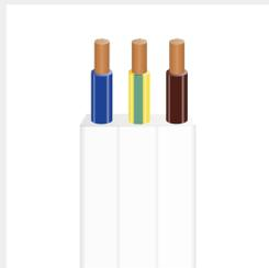
Es una canalización precableada constituida por un conducto rectangular con tres celdillas independientes en cada una de las cuales se aloja un cable unipolar ECO-REVI H07Z1-K (AS). Tanto los cables como el conducto estan fabricados con materiales libres de halógenos
